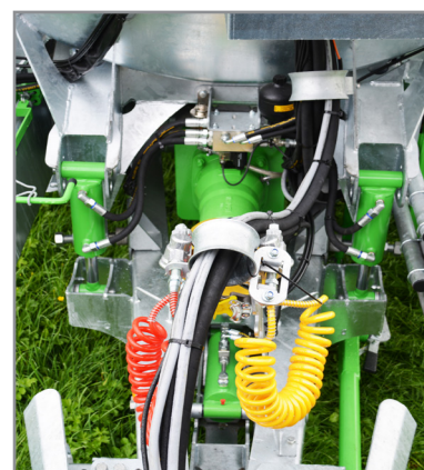
Timon à suspension hydraulique
