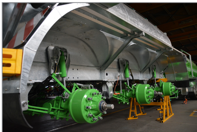
Volumetra 22500 avec encastrement pour grandes roues et train roulant Hydro-Tandem boulonné
